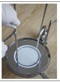
c. 先将上O型圈扣入法兰。
