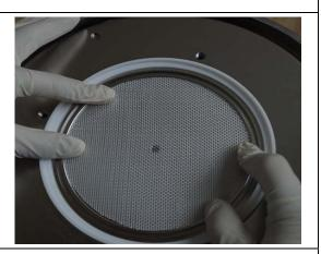
f.将下密封圈装入玻璃定位圈与下筛网 之间。
