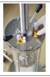
c. 使用前,需拧紧进料口螺母,避免发生漏液风险(进料口密封圈如有损坏需及时更换)。如需外接管路,可将垫片平整放入管路与柱头之间,然后用卡箍锁住,拧紧即可。
