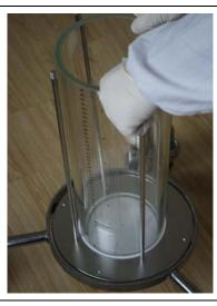
d. 倒扣法兰平整放在玻管上,并使法兰上的4个丝孔正对应4根丝杆。
