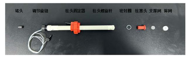
下柱头²:由堵头、软管、底部螺旋杆、调节旋钮、底部固定器、密封圈、筛网、 支撑网、柱塞头等组成。
