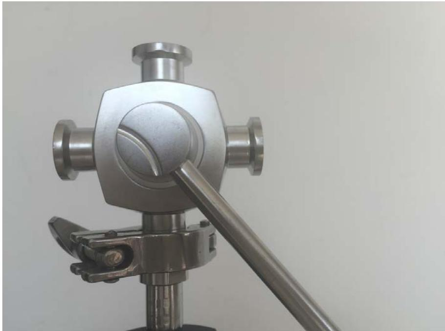
注：四点四通阀使用方法与四点两通阀相同，当 2 个端口相通时，另外 2 个端口自动相通。
