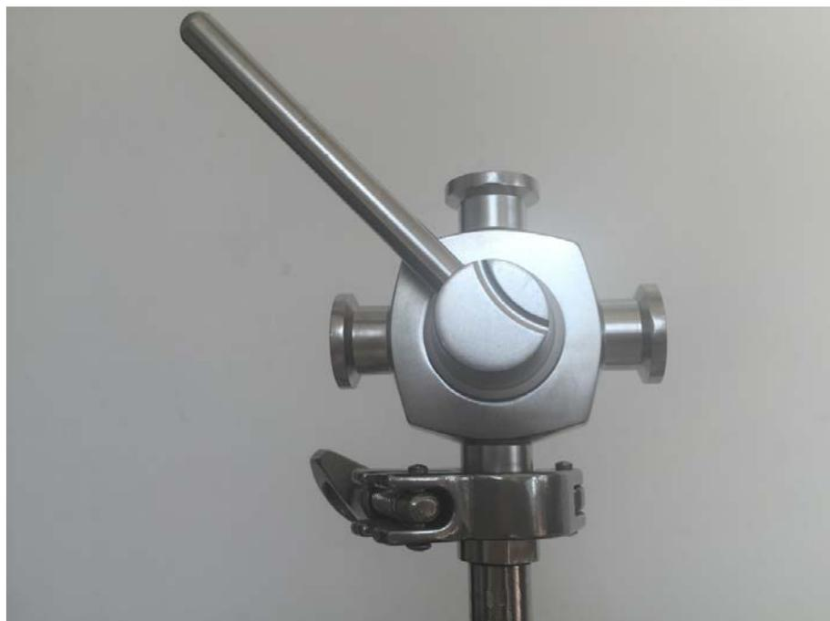
2.3 将手柄继续按逆时针旋转 90 度，此时导向弧指向 1 号与 4 号端口，即 1 号与 4 号端口相通，层析柱仍处于封闭状态。
