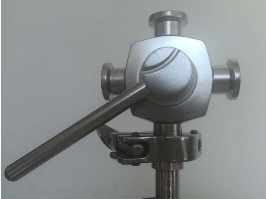
2.4 将手柄继续按逆时针旋转 90 度，此时导向弧指向 4 号与 3 号端口，即 4 号与 3 号端口相通，4 号端口也可以作为废液口，可用于在层析柱柱头密封圈半紧状态下，下压柱头排除层析柱柱体内的气泡。
